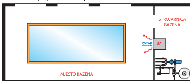
Sustav odvlaživanja ugrađen na zid bez cijevi za odvod
