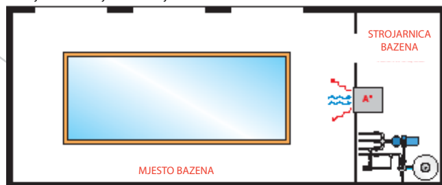
Uređaj za odvlaživanje unutar strojarnice bazena
